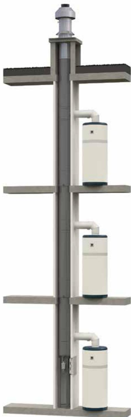
Ubbink propose un système de raccordement CLV pour les chauffe-eau thermodynamiques dans les logements collectifs. L'amenée et l'évacuation d'air se font par un conduit concentrique central. Selon la configuration, il est possible de raccorder entre 1 et 10 chauffe-eau thermodynamiques, avec un maximum de 2 par niveau.
