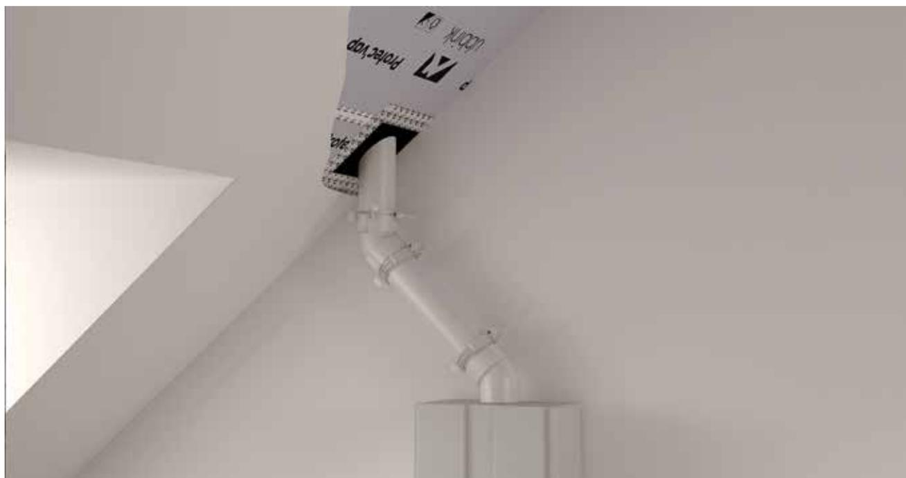
Des mesures de construction étanche ont montré que la plupart des fuites se produisent lors du raccordement des passages de toiture. L'air humide s'échappe de la maison par des fissures le long des passages de toiture et se condense dans la construction du toit. En outre, l'humidité dans le toit peut éventuellement affecter la construction ou provoquer des moisissures. Pour ce problème, Ubbink dispose d'une série de manchons d'étanchéité.
